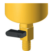
RUBINETTO APERTO DRAIN COCK OPEN КРАН В ОТКРЫТОМ ПОЛОЖЕНИИ
